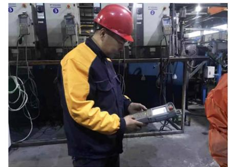
此外,锻造工厂400T1线在安装调试过程中出现了多个问题。在得知安装调试出现连冲情况后,宋德成立即与其他技术人员一起通过线路分析,快速找出问题点进行修指定。之后,调试过程中又出现压力机没压力的问题,经过宋德成及技术人员的排查,确定为刹车档问题,并予以修复。最终,通过一周不断调试,400T1线顺利投入了使用。
